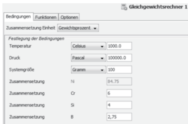
Abb. 2. Festlegung der Bedingungen im Gleichgewichtsrechner, Thermo-Calc
